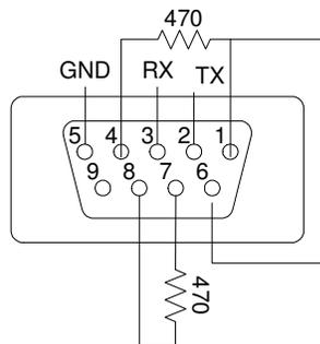
**Figure 20. RS-232 Connector Pin-Out**
