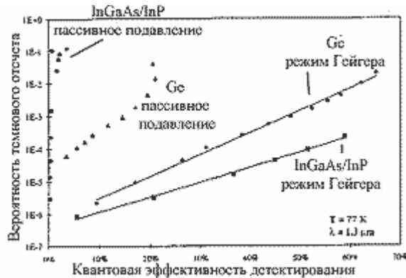
Рис.14. Зависимость вероятности темнового отсчета в смещающем импульсе от квантовой эффективности детектирования 1.3мкм фотонов при температуре 77К в режиме Гейгера.
